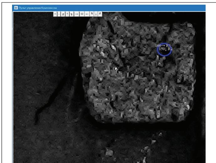
Рис. 7. Измерение дефектов с помощью вписанной окружности (овала)
