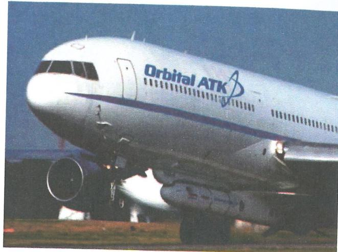
Рис. 9.1. Система запуска Pegasus на самолете Lockheed 011 Jet
