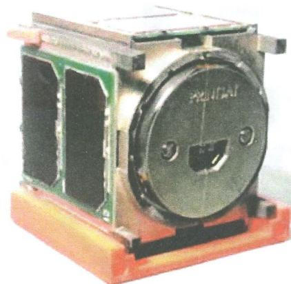
Рис. 5.9. Общий вид спутника PrintSat
