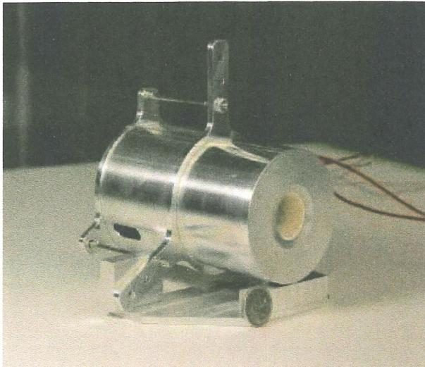
Рис. 3.16. Общий вид толкателя компании UTIAS SFL
